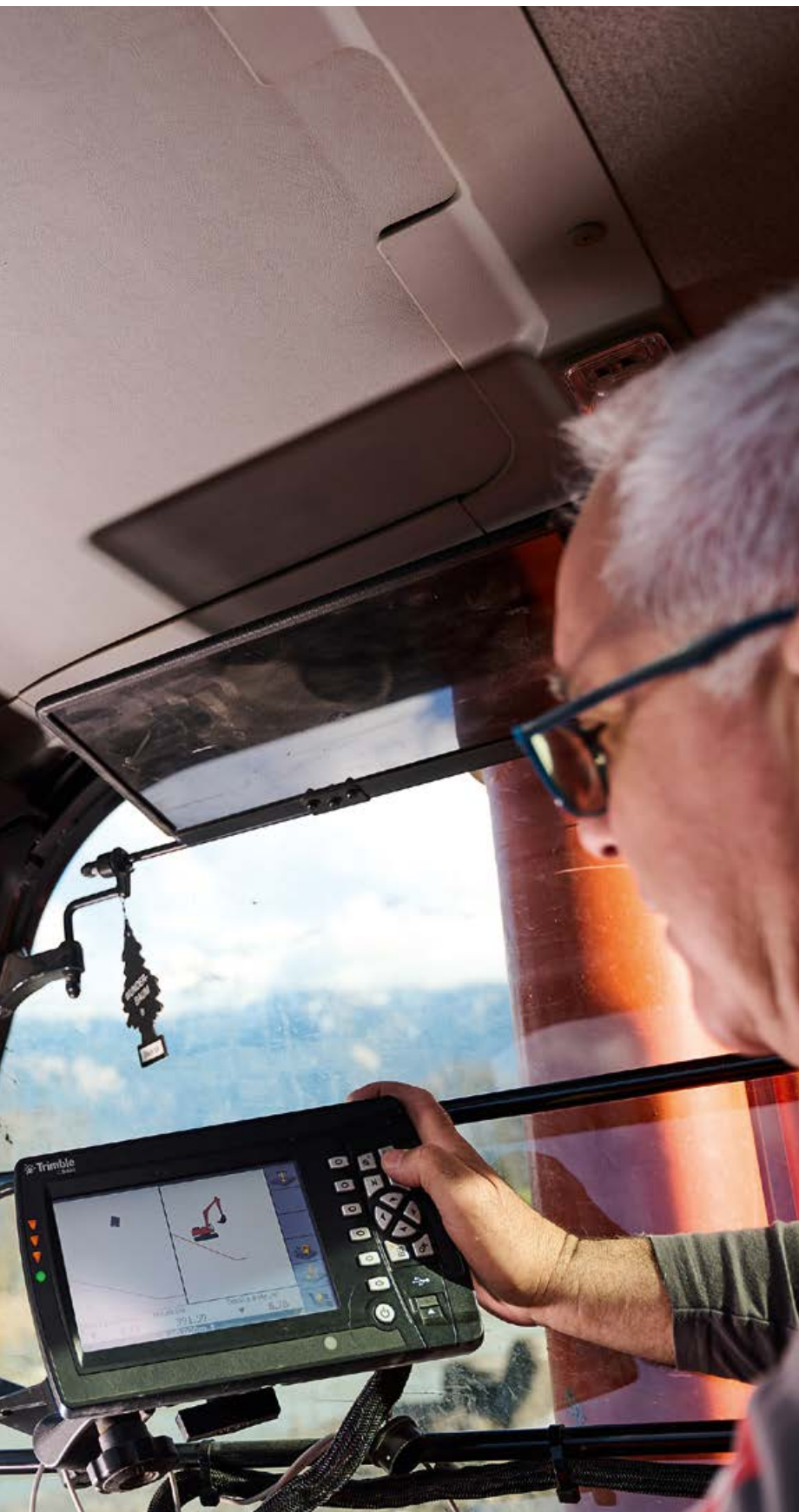
Mit GPS-Systemen ausgestattete Baumaschinen gewährleisten die präzise Platzierung der Verstärkungen für die Sicherungsarbeiten am Rhone.
