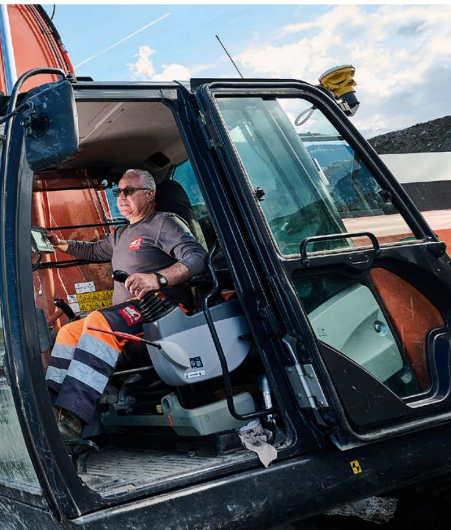
Ein Trimble-GPS-Empfänger, der auf einer Baumaschine montiert ist, ermöglicht eine millimetergenaue Positionierung der Arbeiten.
