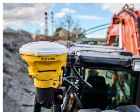
Ein Trimble-GPS-Empfänger, der auf einer Baumaschine montiert ist, ermöglicht eine millimetergenaue Positionierung der Arbeiten.
